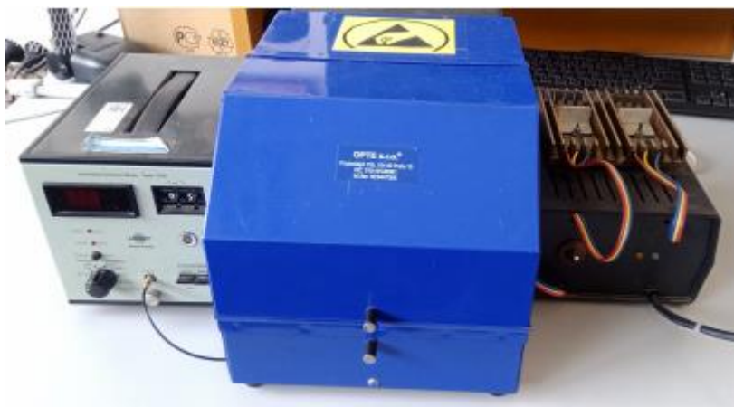
Obr.4 Sestava směrového reflektometru OPTE-F3K.
