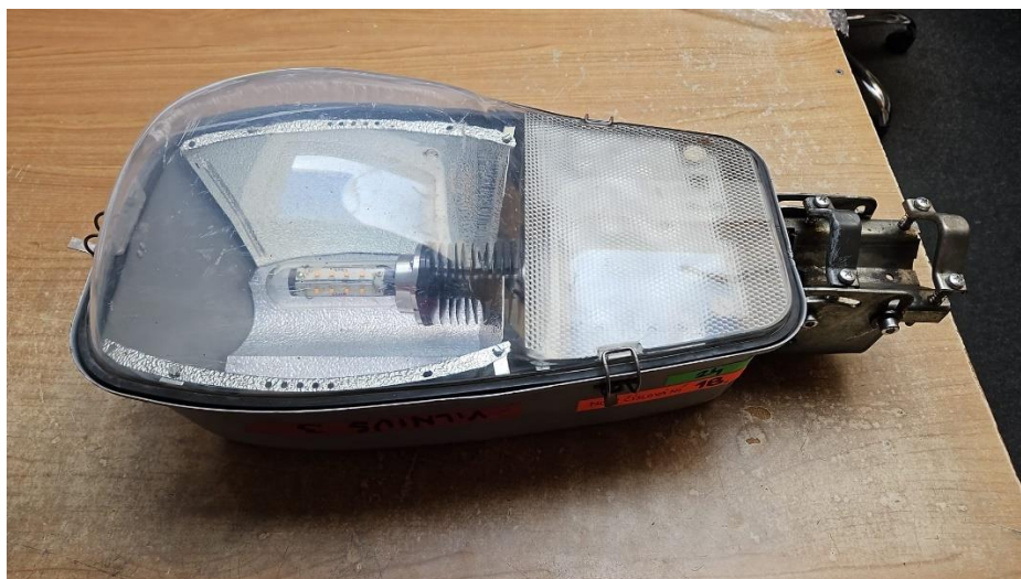
Obr.11 Jedno ze svítidel připravených k instalaci pod Dvorecký most s již osazeným LED záměnným světelným zdrojem (retrofitem) umožňující stmívání prostřednictvím DALI předřadníku
