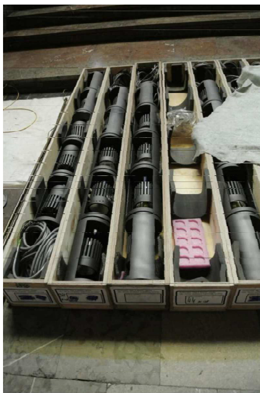
Obr. 12. Svítidla připravená k instalaci.
