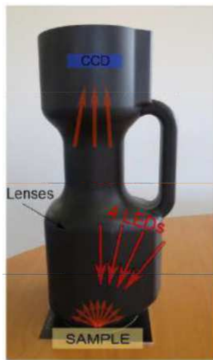
Obr. 4 Princíp merania BRDF
