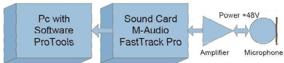
• obr. 2 Blokové schéma záznamového zařízení pro spektrální analýzu
