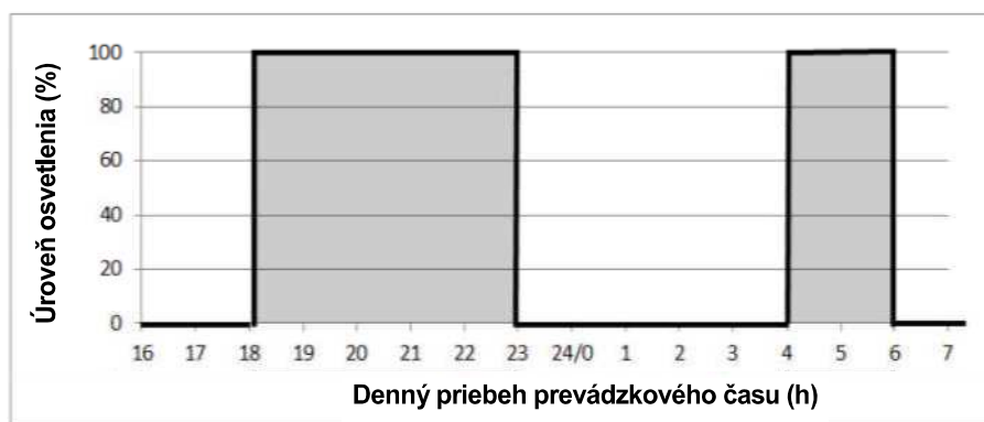
• Obr. 3 Riadiaci profil s vypnutím osvetlenia v nočných hodinách
