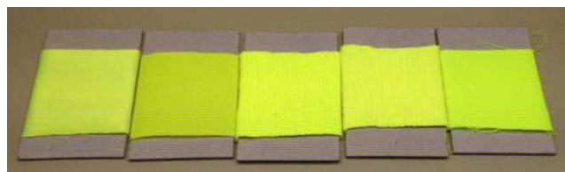
obrázek 10 Barevný vzhled žlutých testovacích standardů LCAM pod simulátorem D65 na bázi F7 s UV zářením
