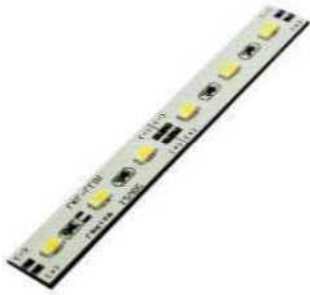
Obr. 2 Lineárny SMD LED modul
