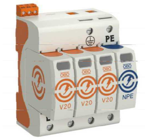
• Obrázek 4: Sestava SPD typu 2 pro síť TN-S s mechanickou aretací zasunutého horního dílu a přepínacím kontaktem dálkové signalizace
