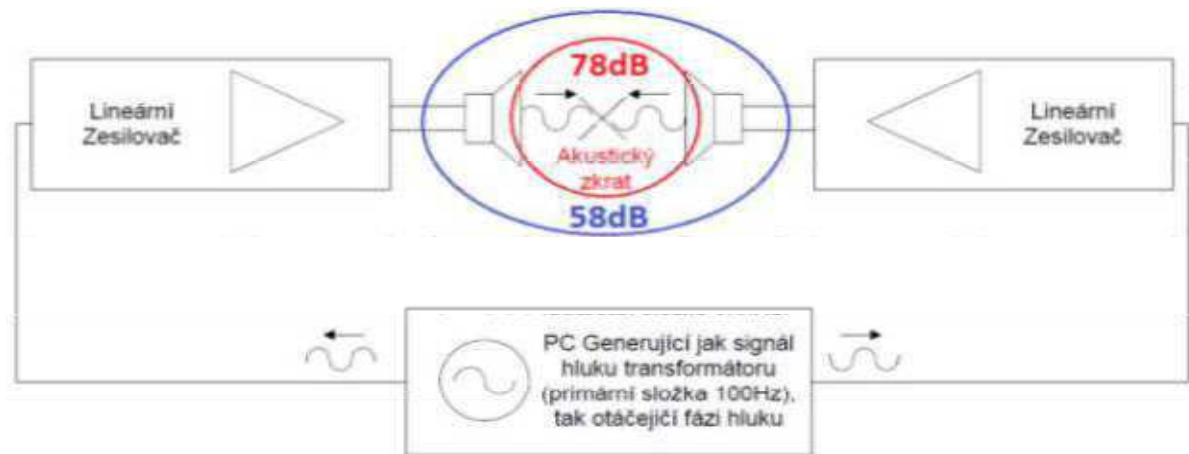
• obr. 7 Blokové schéma prototypu Protifázového eliminátoru
