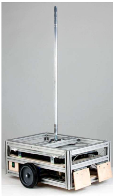
• obrázek 1: Konstrukce robotické jednotky pro měření osvětlenosti v interiérech [1]
