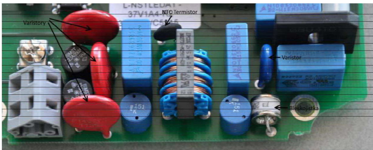
Obr. 4 Prvky pro ochranu proti přepětovým a proudovým špičkám
