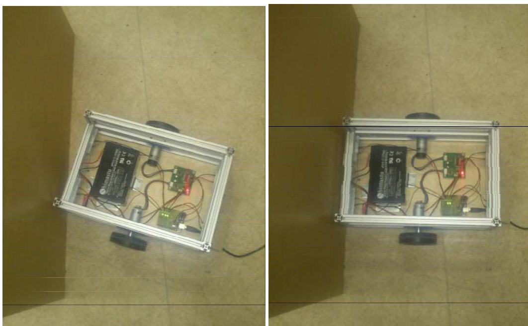
• obrázek 6: Testování detekce stěny a natočení robotické jednotky rovnoběžně s touto stěnou
