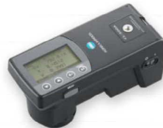
• obrázok 2 Spektofotometre použité pri meraní odrazivosti svetla „Fotometrického náteru“. A. Spektofotometer Konica Minolta CM - 5. B. Spektofotometer Konica Minolta CL 500 – A.
