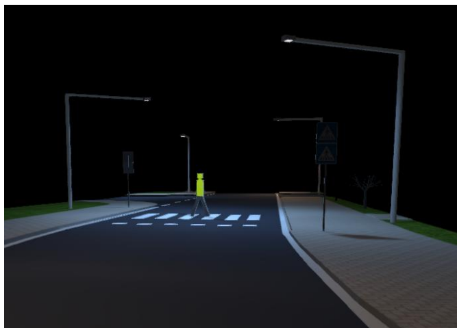
Obr. 15: Optimalizovaný přechod s chodcem v základním prostoru realizovaný pomocí programu Dialux
