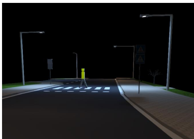
Obr. 16: Reálný přechod s chodcem v základním prostoru realizovaný pomocí programu Dialux
