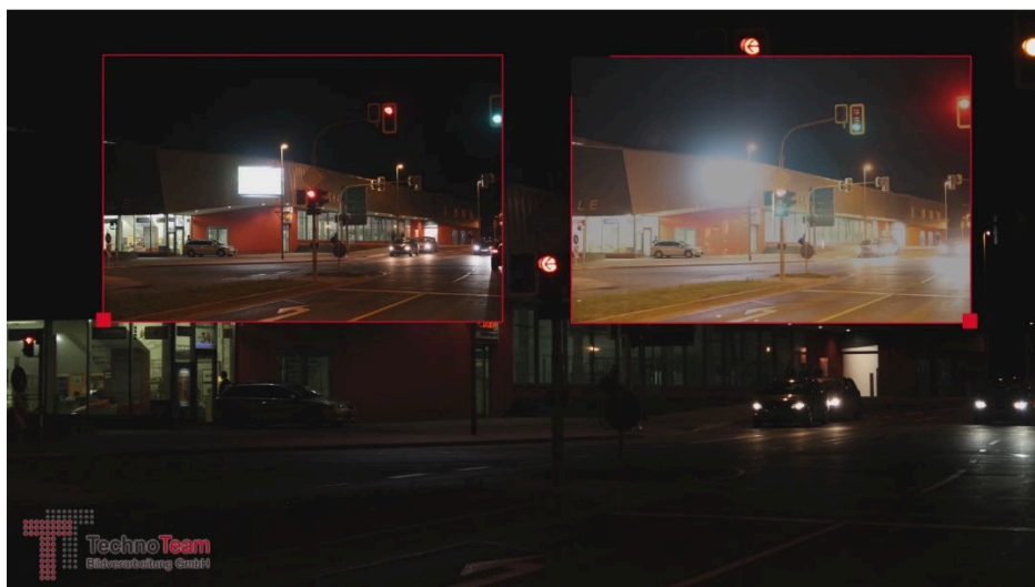
Obr.20 Hodnocení vlivu světelné reklamy na rozpoznatelnost barev signalizace světelně řízené křižovatky foto viz zdroj manuálu LMK Laboratory Software, fa TechnoTeam Bildverarbeitung GmbH, www.technoteam.de
